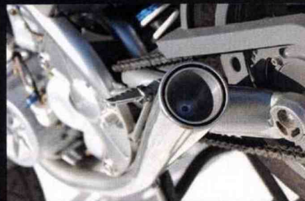
L'échappement : un tromblon par cylindre, de chaque côté.
